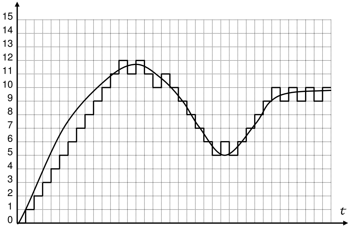
Şekil-13.19 İzleyici ADC'de izleme işlemi ile üretilen dalga biçimi.
