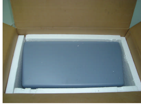
Resim 3.10:Ambalajlanmış parçanın köpüklerle kutuya konulmuş hâli
