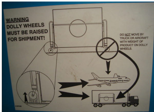
Resim 3.17: Dolly'nin taşınması sırasındaki kuralları gösterir etiket
